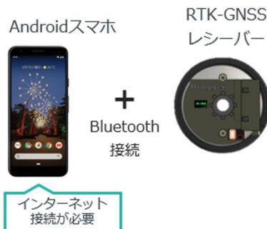
図 2 RTK 法のシステム構成
